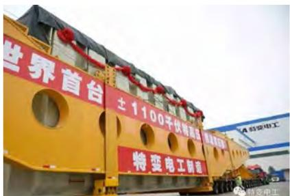
6月21日，世界首台 ±1100 千伏特高压换流变压器在新疆发运，装载着这个“巨无霸”成功发运的WS系列液压组合挂车属于重大件运输车辆，由2~8轴线模块运输车组成，通过连接牵引杆可形成全挂车辆或连接动力鹅颈可形成半挂车辆，模块之间通过横向纵向拼接可满足不同形状与重量的货物运输需求。截至2018年5月，中国航天科工在国内外共计销售液压组合挂车2000余轴线，成为国内唯一生产全系列自行式模块和液压组合挂车的厂家，为振兴国家装备制造业和推动物流企业整体进步贡献力量。
