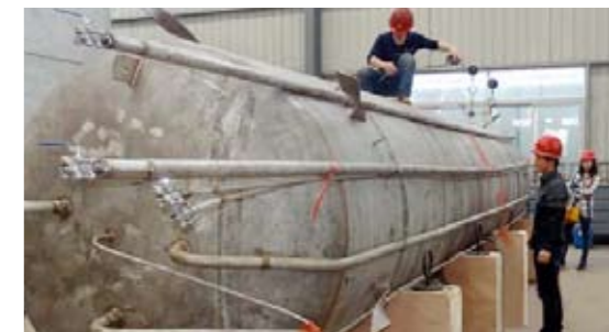
贮罐水压试验准备现场
