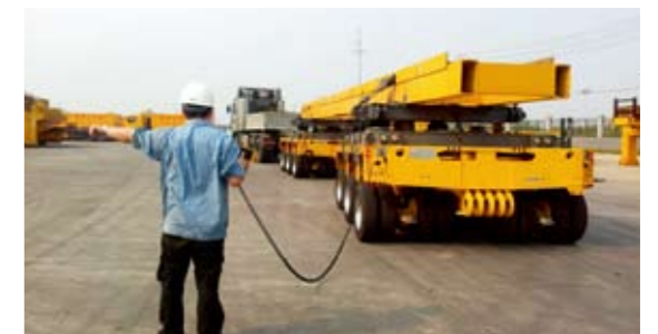
中国航天科工四院万山公司为巴西研发的200吨转盘成功交付用户。200吨转盘是用在模块式组合液压挂车上，运输重量不超过200吨超长货物的辅助设备。这标志着该公司在充分借助航天技术优势，创新发展军民融合产品市场方面再次取得重大突破。
